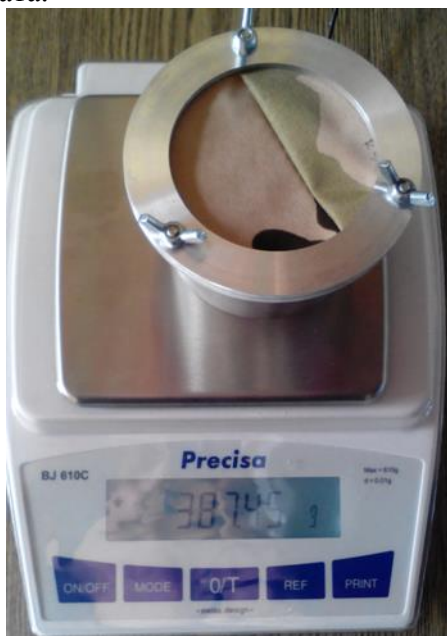
Фиг. 3 Термоаналитична везна с подготвената проба
