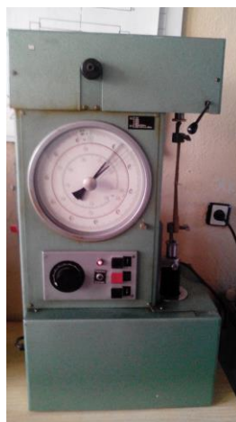
Фиг.2 Опитен стенд за здравина на шева
